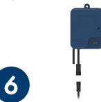
Branchez le connecteur de câble de la sonde sur le câble court du module CO.
