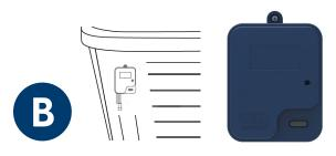
Vissez le module CO à l'aide d'une vis à tête cylindrique no 8 en laissant du mou dans le câble.
