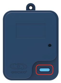
Le module CO de l'in.touch 3+ est également doté d'un bouton qui comporte un voyant DEL d'état. L'objectif principal du voyant DEL est d'identifier l'état de la sonde Gecko waterlab ou, comme mentionné dans la section relative à l'application, d'entrer dans des modes particuliers tels que le mode d'étalonnage ou de prélever des échantillons sur demande.
